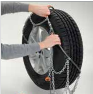
RUDcompact® Seilmontage Praktisch bei Frontantrieb: Die Compact-Montage. Einfach zusammenhängen und spannen.
